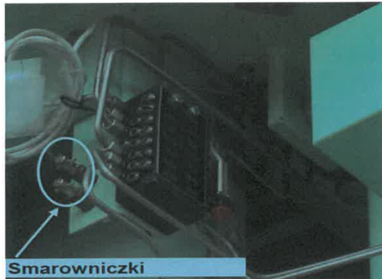
Rys. nr 6.13.18. Widok smarowniczek smarowania obudowy szczelnej ramy wybieraka śrubowego.
