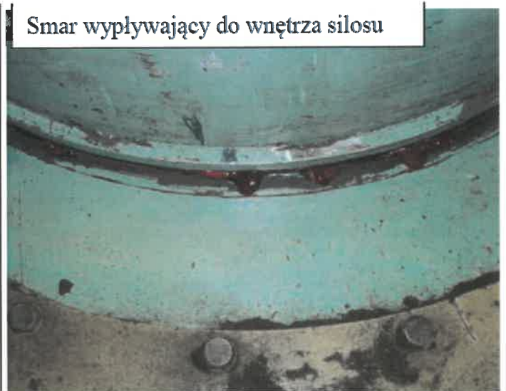
Rys. nr 6.13.19. Wypływ smaru do wnętrza silosu w trakcie prowadzenia czynności smarnych.
