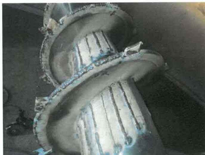
Rys. nr 6.13.17. Widok śruby wygarniacza w trakcie napawania śruby.
